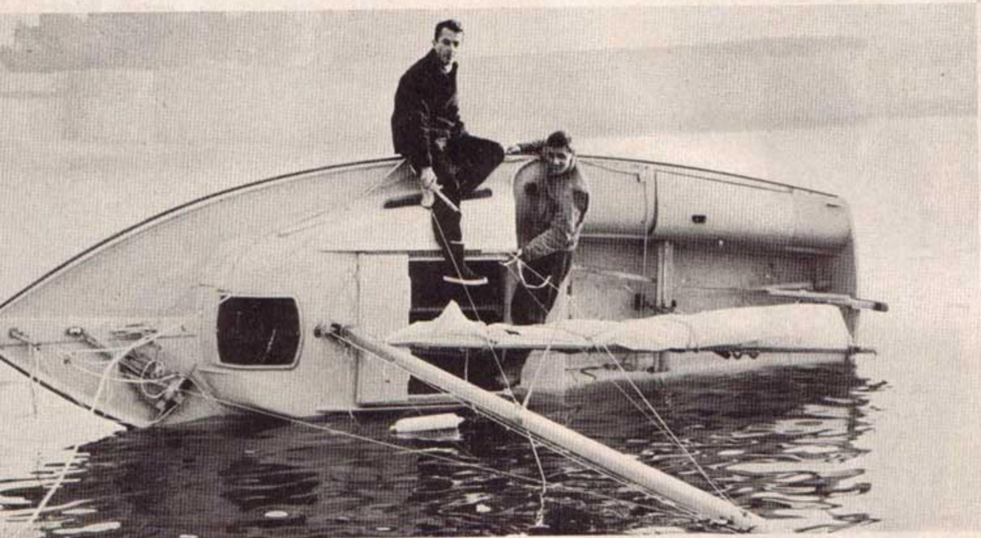
Les panneaux ouvrant sur les parties accessibles des caissons sont, pour l'instant, d'une étanchéité toute symbolique.
