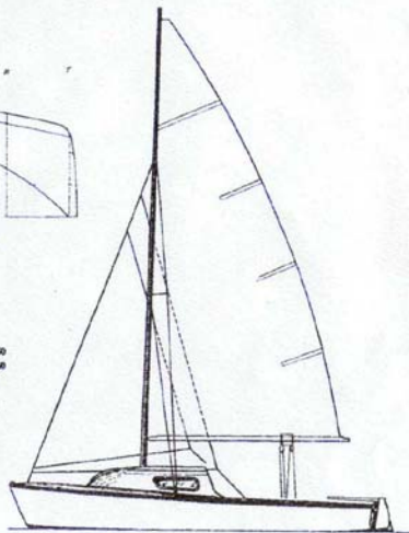
Plan de voilure au 1/60'
